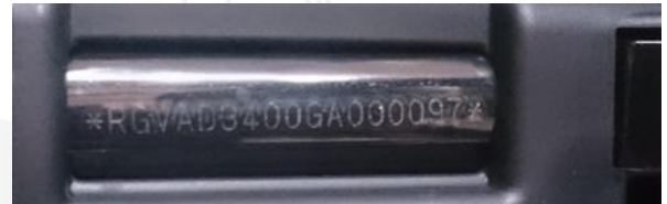
車架/底盤號碼 在坐墊下的右後方
