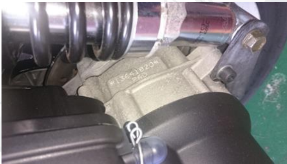
引擎號碼 在左側避震器下鎖點前方
